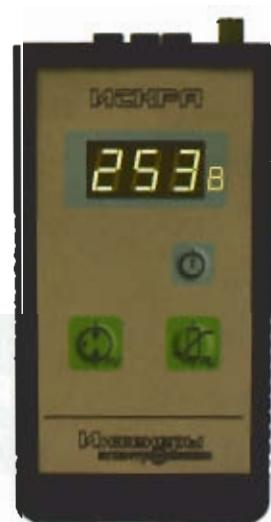
Рис. 1. Прибор проверки параметров устройств и элементов защиты «ИСКРА»
