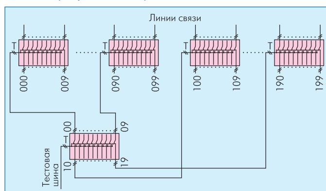
Рис.7 Устройство подключения тестовой шины емкостью 200 линий
