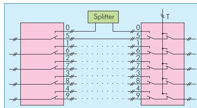
Рис.5 Пример устройства переключения сервисов емкостью 5 линий
